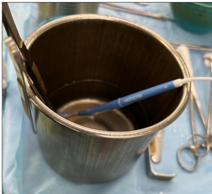
Рисунок 3 – Откалиброванный датчик находится в стерильном физиологическом растворе
