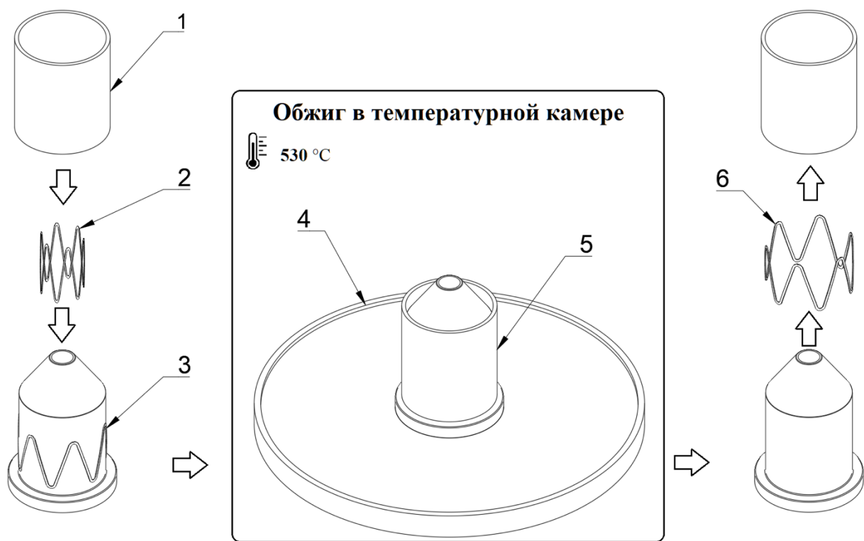
Рисунок 31 - Процесс термоформования: 1 — внешний корпус фиксирующей матрицы; 2 — заготовка каркаса стенового элемента; 3 — расширенный до требуемого диаметра стеновый элемент, расположенный на внутренней части фиксирующей матрицы; 4 — установочная площадка внутри камеры специализированной муфельной печи; 5 — фиксирующая матрица в сборе с термоформуемым каркасом, расположенные внутри камеры для обжига; 6 — термоформованный каркас стенового элемента
